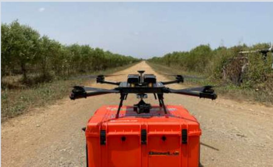
**TRASPORTO FACILE** – Il telaio è richiudibile in senso orizzontale per limitare gli ingombri; l'interasse in modalità di volo è di 1,3 metri ma richiuso è solo 53x53cm.
