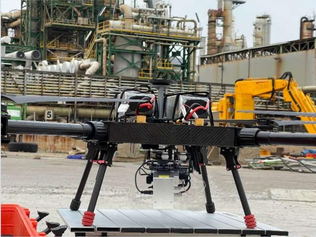
Esempio di installazione **LiDAR** su SkyQUBE
